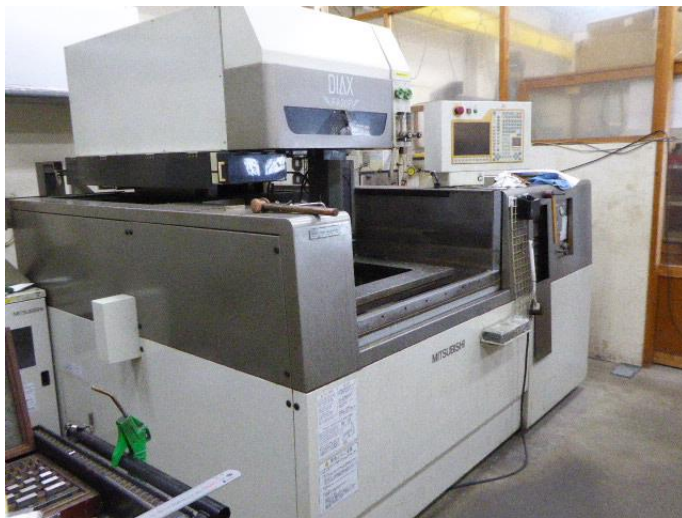
ワイヤーカット 三菱電機 FA20 2002 制御装置 W21FAP-2 テーブル 780×630 mm ストローク(XYZ) 500×350×300 (UV) ±32 mm
